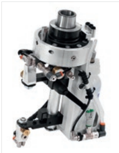
Станок обдува и распыления антиадгезионной жидкости.
