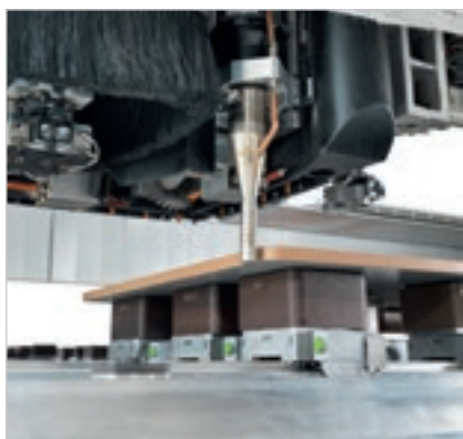
Продувочная группа с холодным или горячим воздухом.
